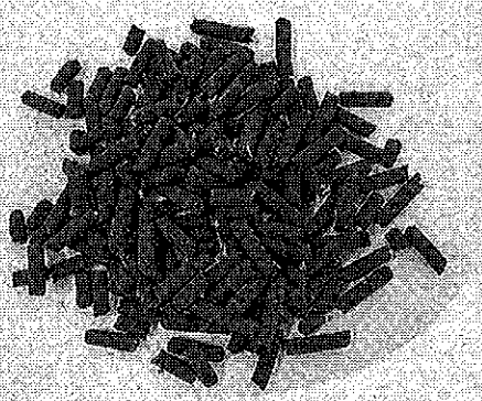
廃棄飲料は固形状のバイオマス燃料に加工される
