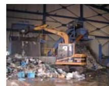
破碎することで、かさばる廃棄物の減容化や金属付着物から分離された金属資源の回収ができます。
